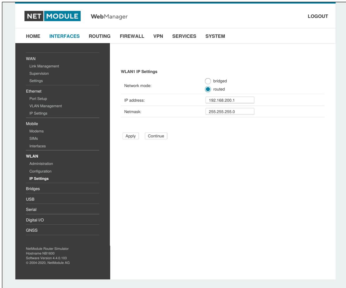
Abbildung 6.19.: WLAN-IP-Konfiguration
