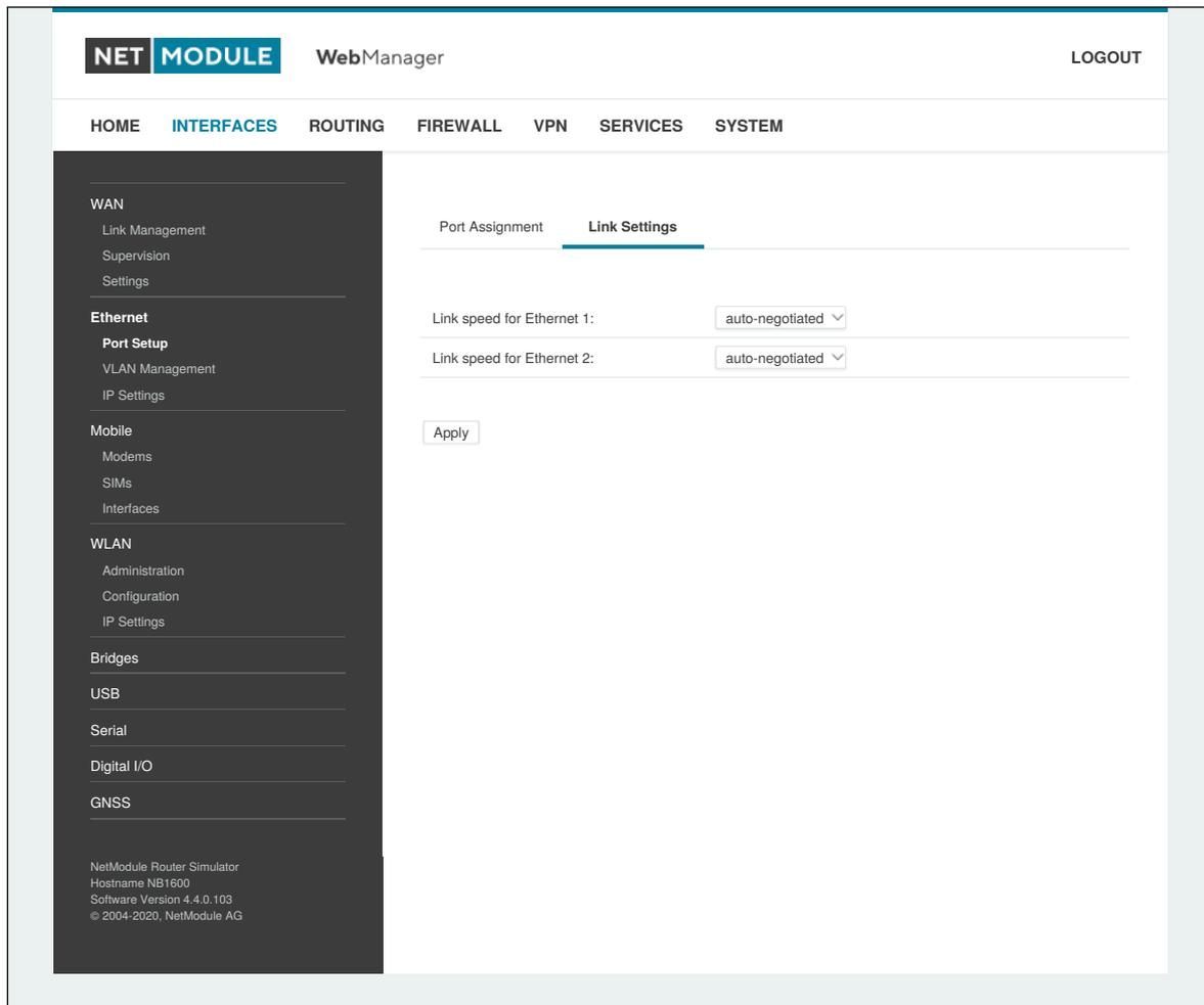
Abbildung 6.7.: Einstellungen für die Ethernet-Verbindung
