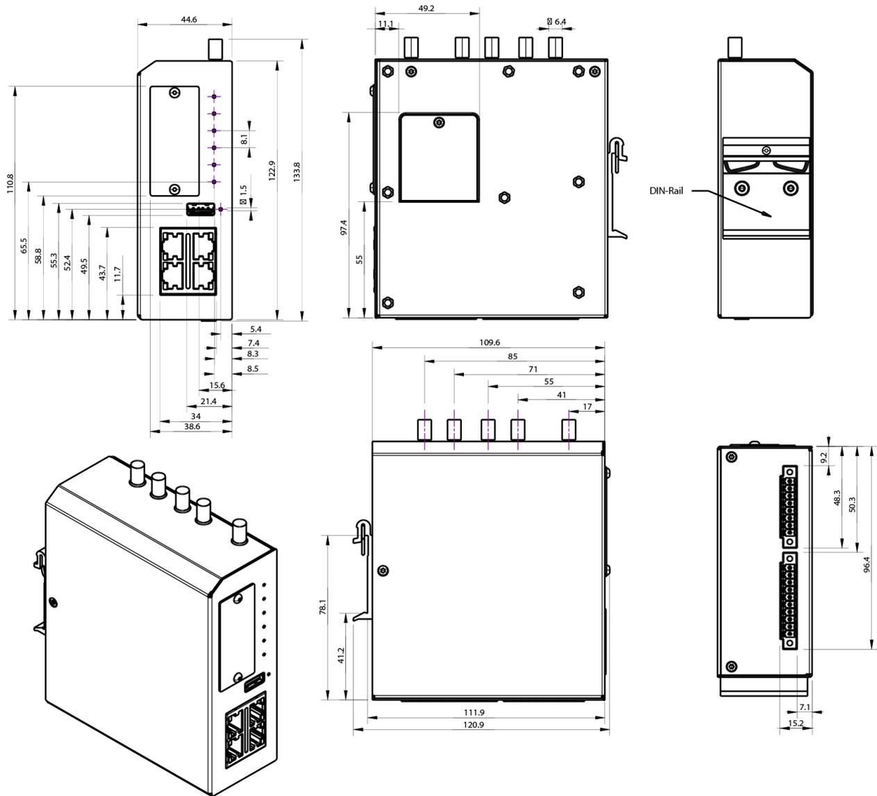
**Hinweis:** Umriss mit Antennen A1-A5 (2x LTE, 2x WLAN/BT, 1x GNSS). Bestellnummer z. B. NB1601-LWWtSc-G (mit COM/IO-geschirmtm EXT 1, ohne Erweiterung EXT 2)
