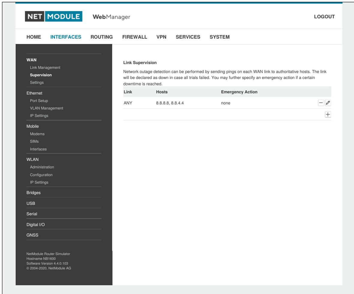
Abbildung 6.4.: Verbindungsüberwachung
