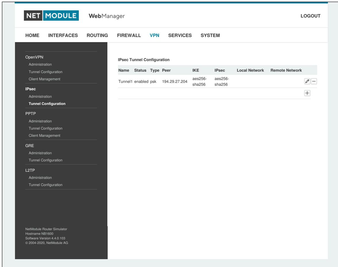
Abbildung 6.33.: IPsec-Konfiguration
