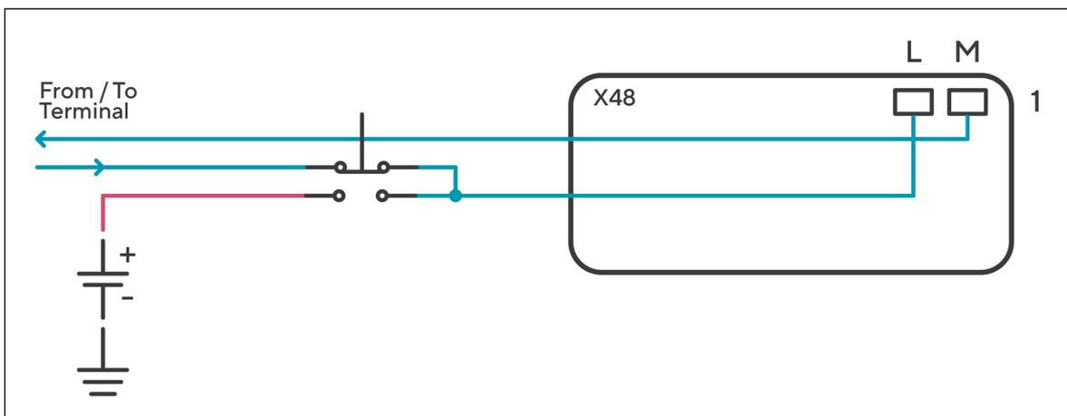
Abbildung 4.2.: Reset-Eingang (serielle Schnittstelle verwendet)
