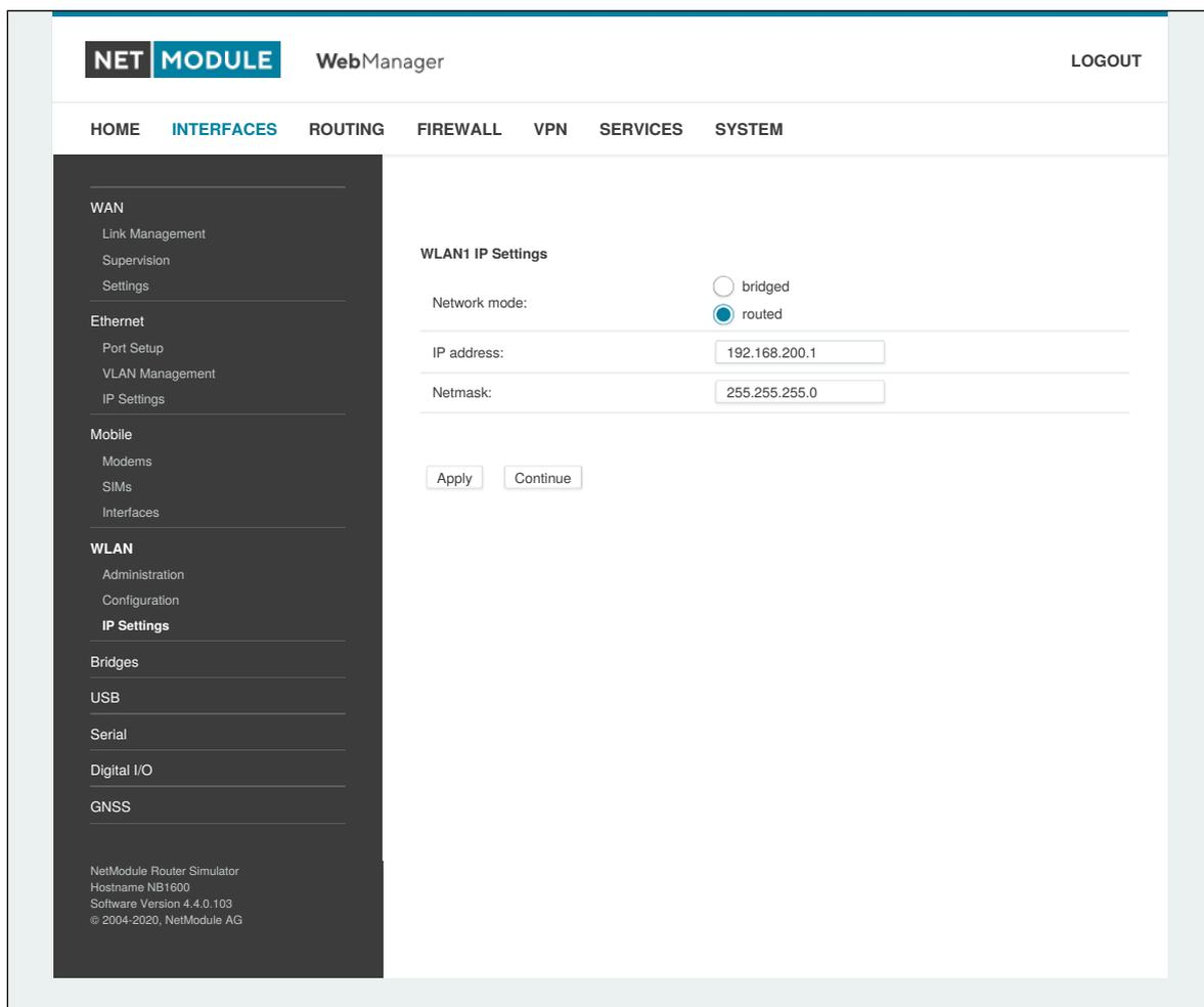
Abbildung 6.18.: WLAN-IP-Konfiguration
