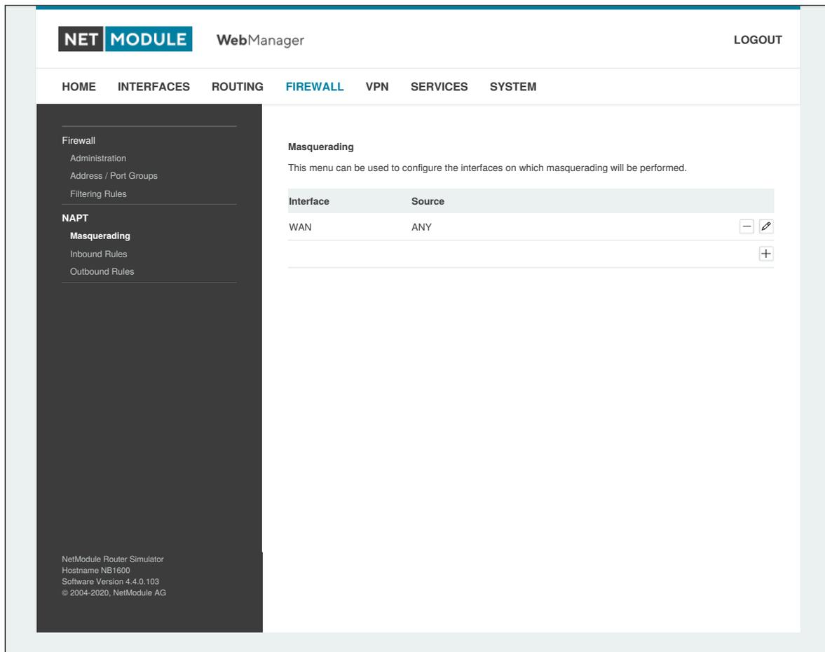
Abbildung 6.27.: Maskierung (Masquerading)
