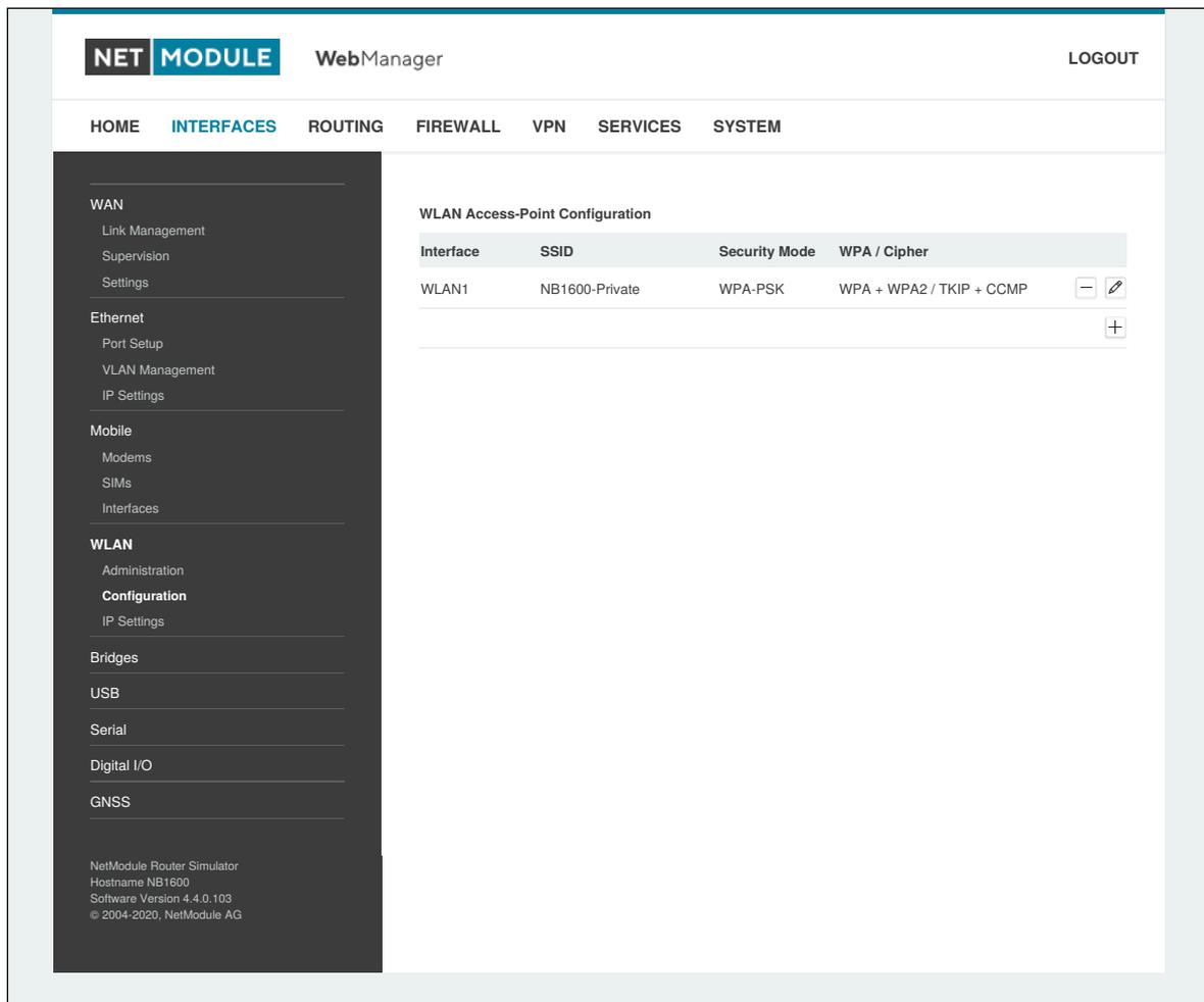
Abbildung 6.17.: WLAN-Konfiguration
