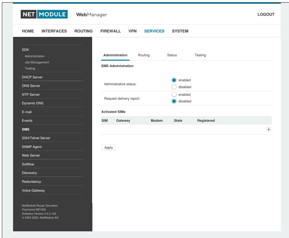
Abbildung 6.47.: SMS-Konfiguration
