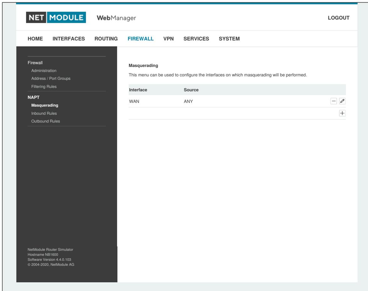
Abbildung 6.29.: Maskierung (Masquerading)
