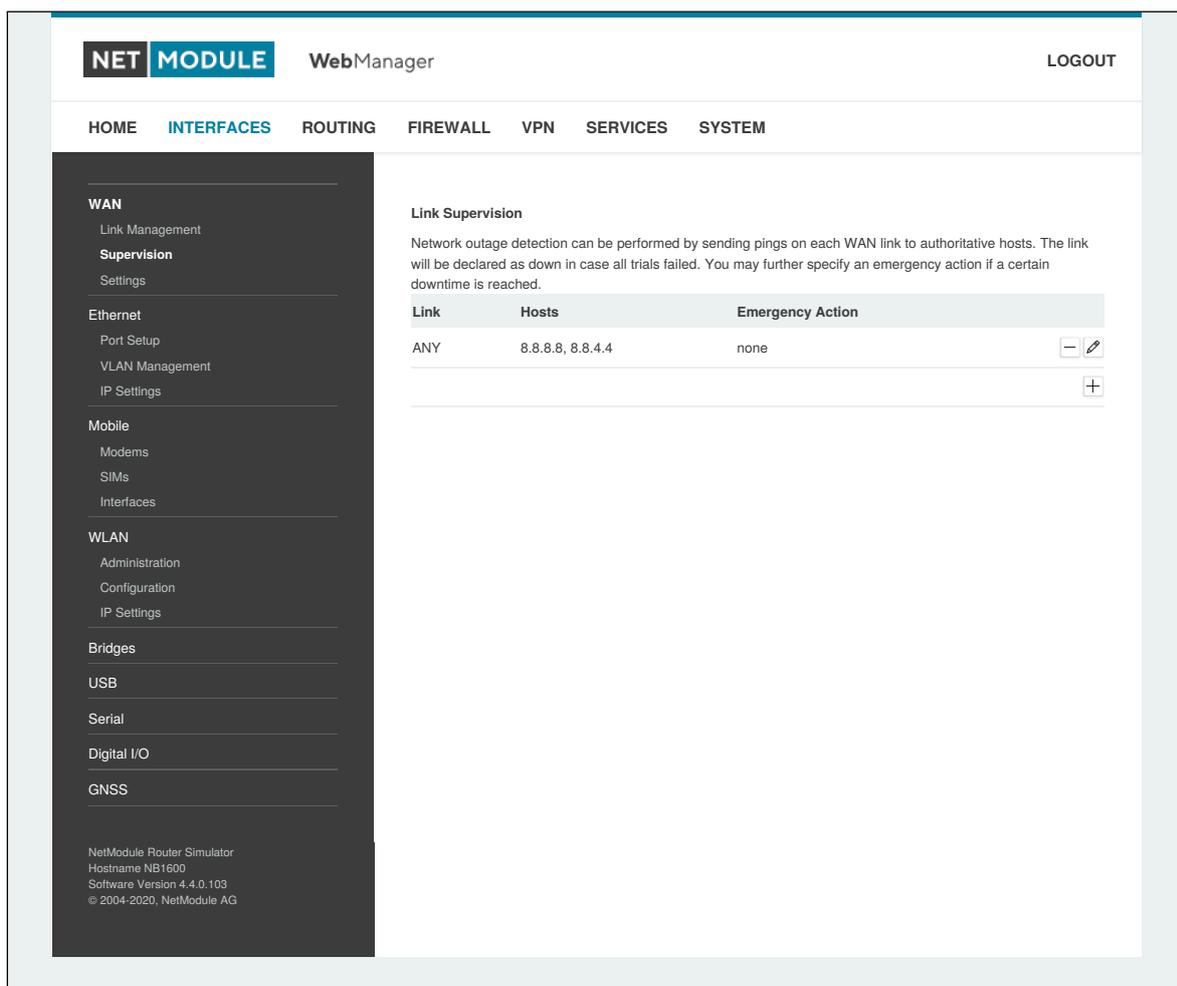
Abbildung 6.3.: Verbindungsüberwachung
