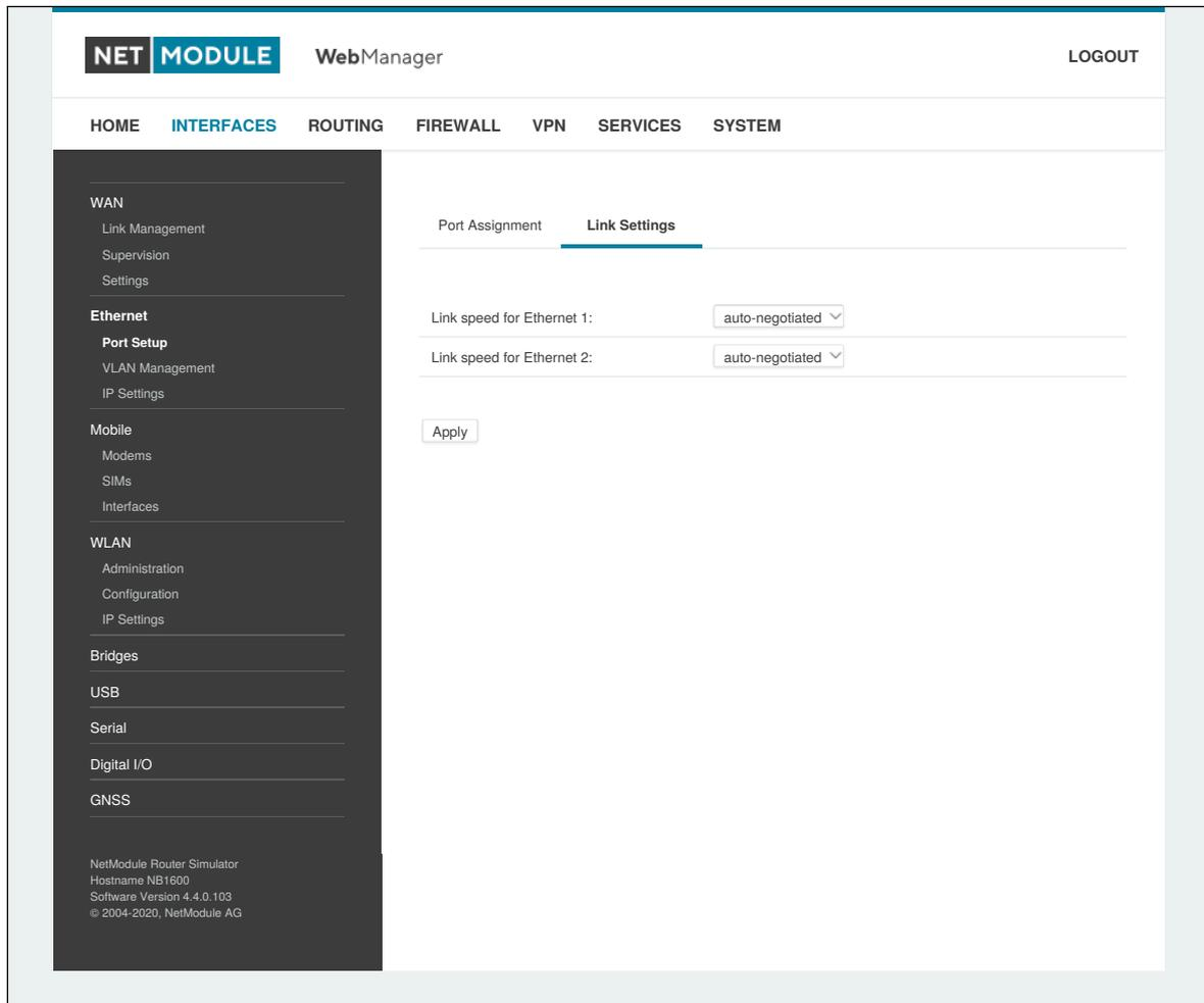
Abbildung 6.6.: Einstellungen für die Ethernet-Verbindung
