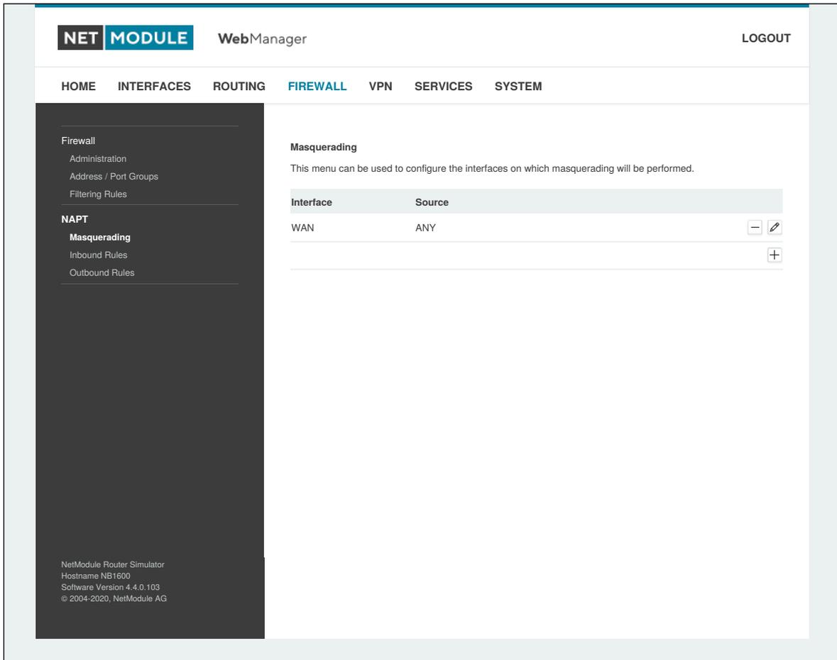
Abbildung 5.25.: Maskierung (Masquerading)
