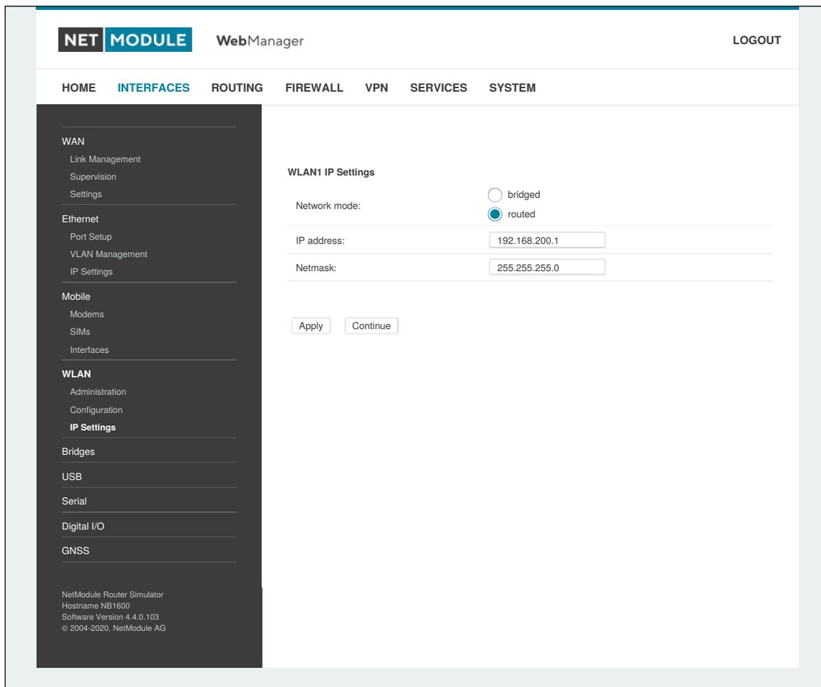
Abbildung 5.14.: WLAN-IP-Konfiguration
