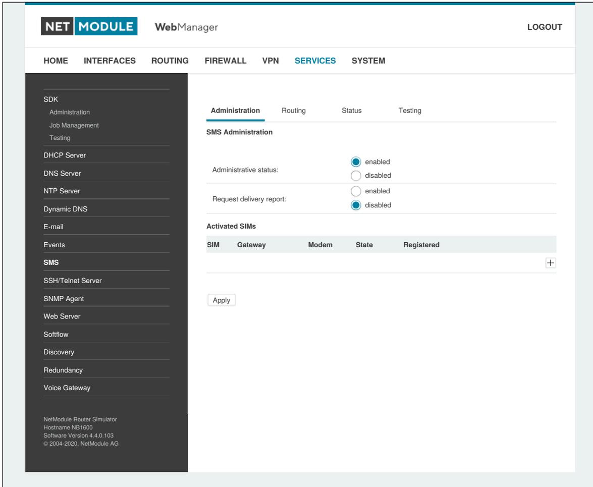
Abbildung 5.49.: SMS-Konfiguration
